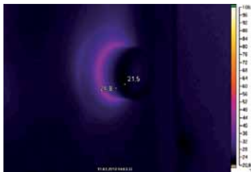
Zdjęcie w podczerwieni przyłącza izolowanego
