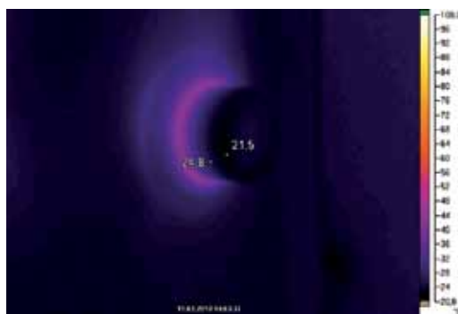
Zdjęcie w podczerwieni przyłącza izolowanego
